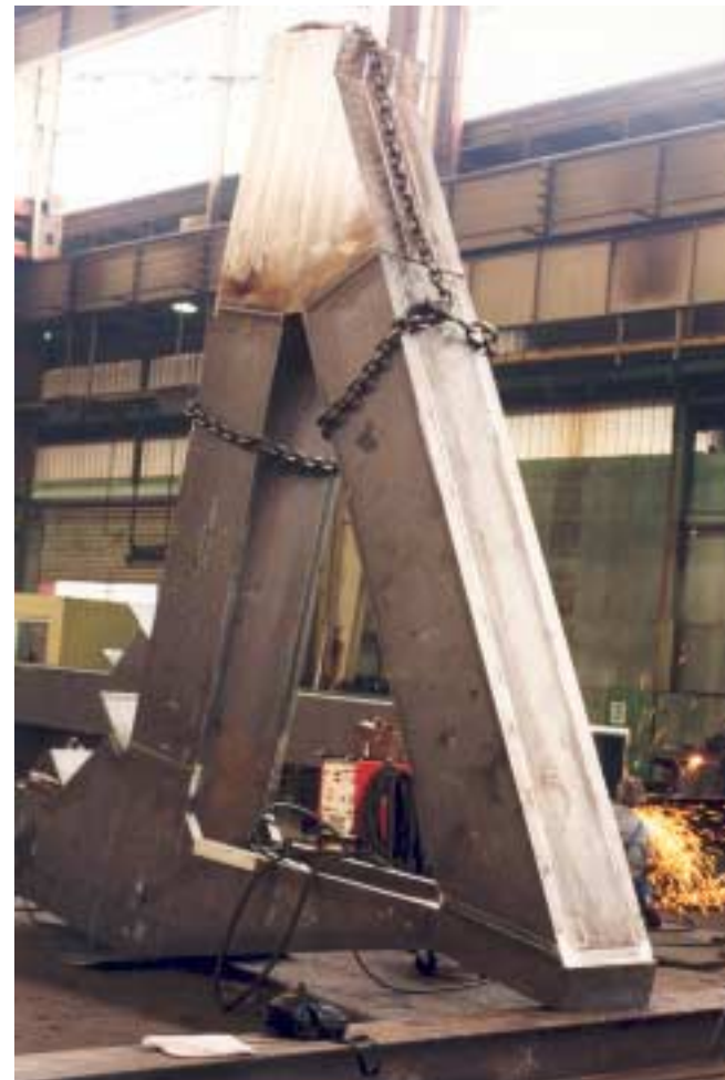
Statik, Konstruktion, Prüfung und Bauüberwachung von schwerem Stahlbau mit hochfesten geschweißten Feinkornbaustählen - SONY Center Berlin, Haus F (Esplanade)
